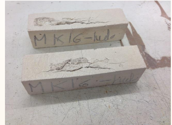
Mortero de cal con MK 20% + 0,5% LS
