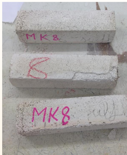
Mortero de cal con MK 20% + 0,5% PNS
