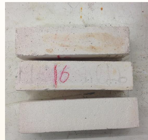
Mortero de cal con MK 20% + 0,5% LS
