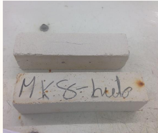
Mortero de cal con MK 20% + 0,5% PNS
