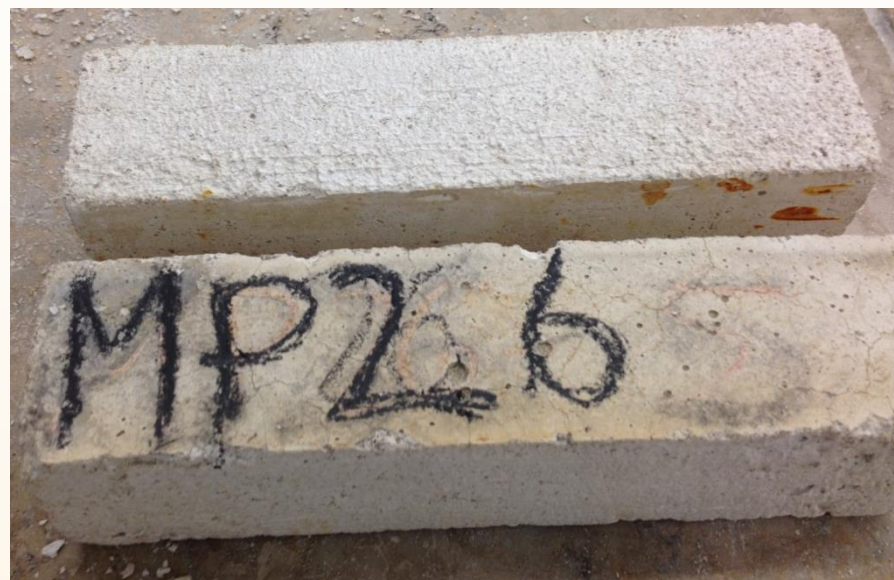
Mortero de cal con NS 10% + 0,5% PNS
